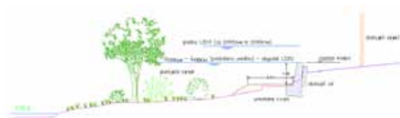
Slika 4: Visokovodni zid ob obstoječem zidu
