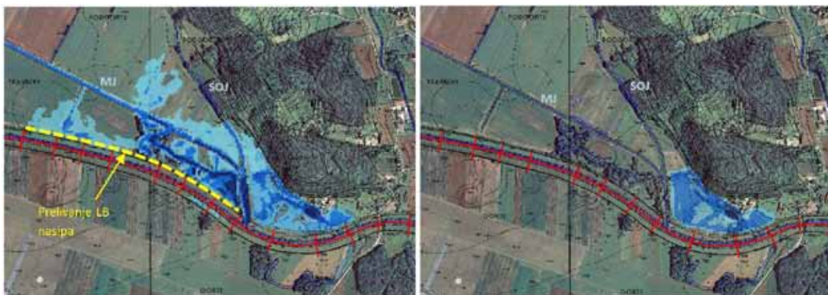
Slika 6: Primerjava izračunov matematičnega modela z upoštevanjem maksimalne kote nasipa iz terestričnega posnetka prečnih profilov (slika levo) in LIDAR-posnetka (slika desno).
