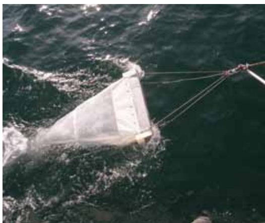
Slika 8: Prikaz vleke epineustonske mreže za vzorčenje mikroplastike v morju (foto: Palatinus, A.).
