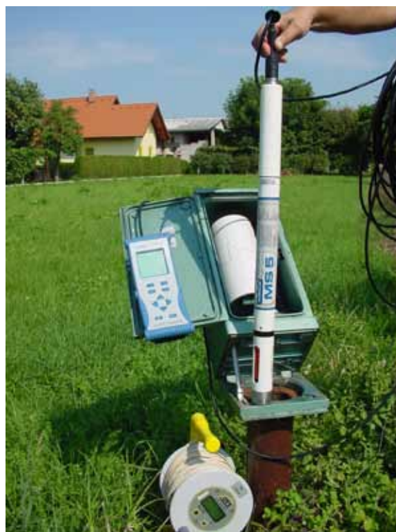
SLIKA 2: Meritve vsebnosti nitrata v podzemni vodi za potrjevanje veljavnosti rezultatov modela WofE (Žalec, Spodnja Savinjska dolina).
