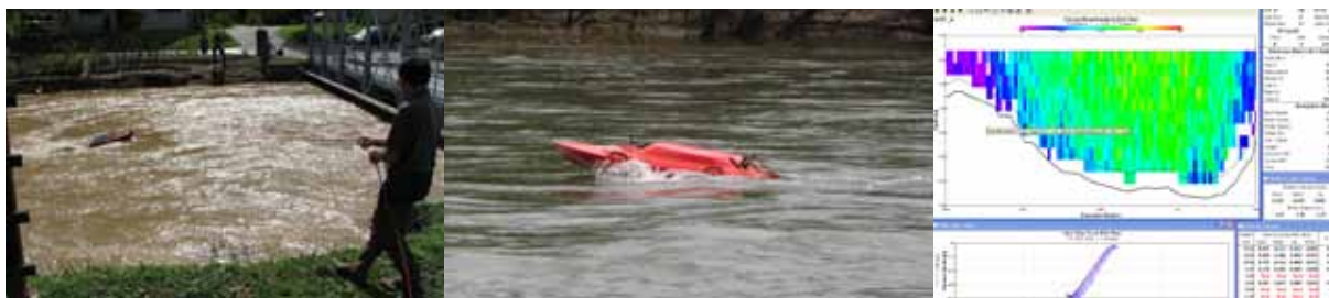
Slika: Meritev pretoka z ADMP, najnovejši daljinsko vodeni ADMP (Q boat), meritev v programu WinRiver.
