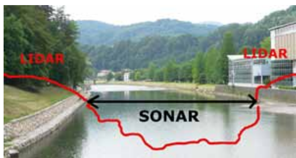
Na sliki: Dejanski prečni profil vodotoka sestavimo iz sonarskih podatkov za rečno dno in LIDAR- podatkov za brežine.
