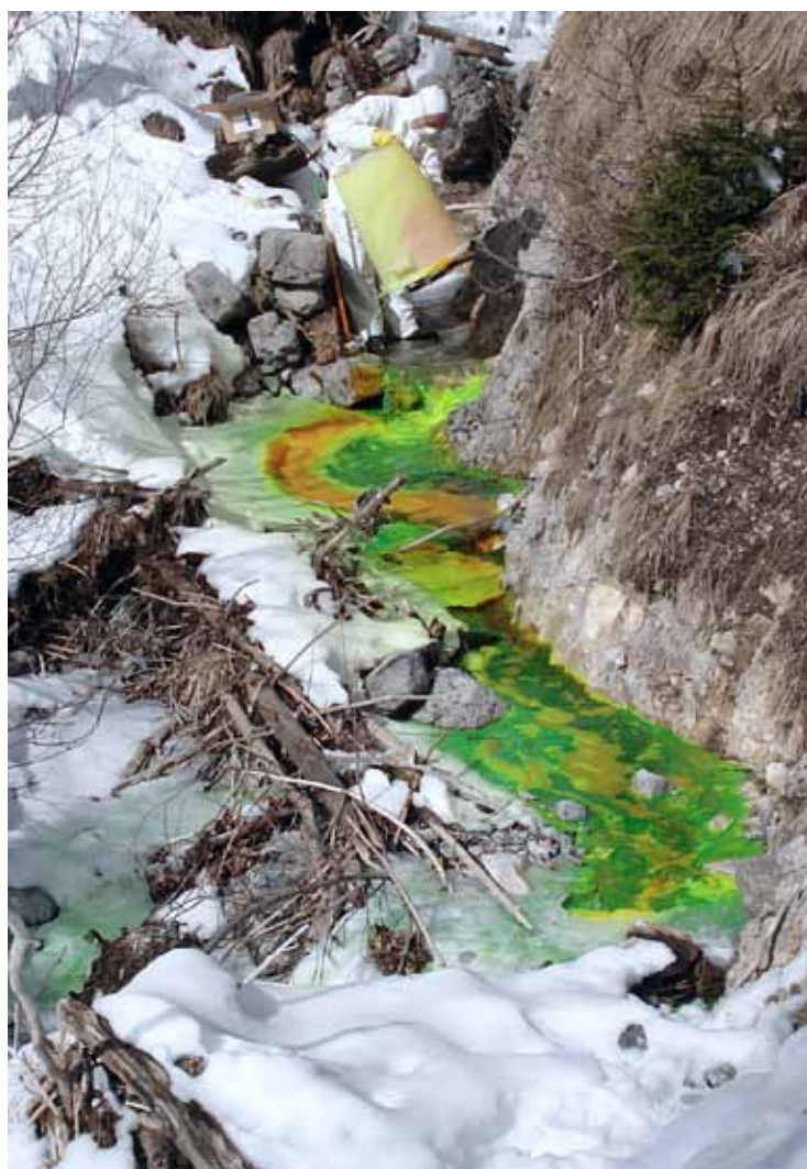
SLIKA 1: Injiciranje sledila uranin v Presušnik 10. marca 2011 (foto: N. Trišič).
