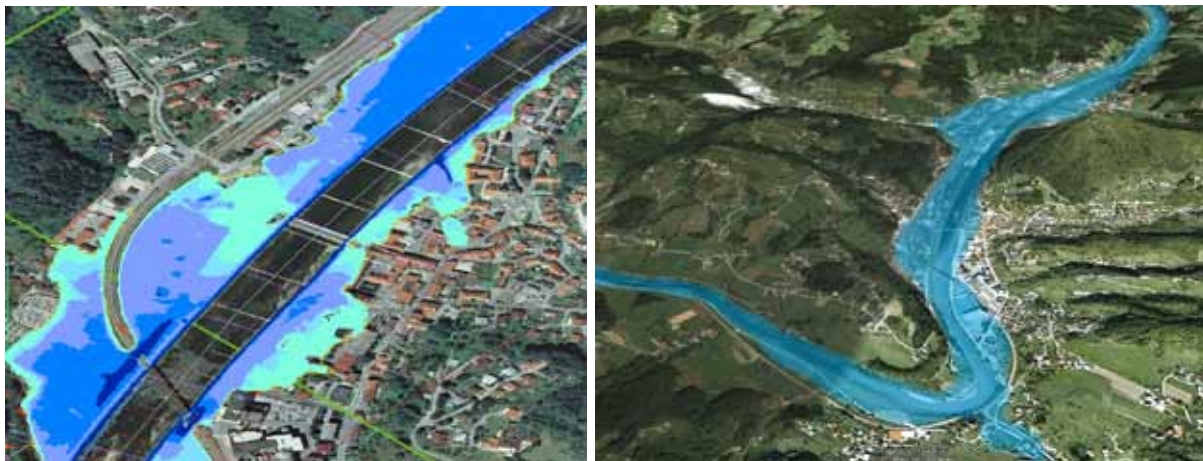
Na slikah: Izris poplavnega območja na 3D terenu (Civil 3D in River Analysis, gladine prenesene iz Hek-Rasa, reliefna podloga Google Earth)
