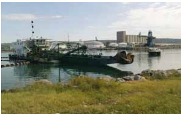
Slika 3: Sesalni bager za poglobljanje
