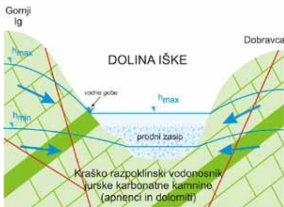
Slika 5. Poenostavljen hidrogeološki profil prek doline reke Iške (skica ni v merilu)
