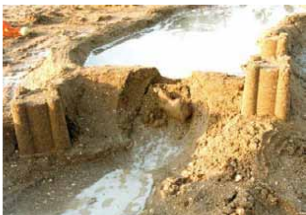
Slika 4: Erozijski kanal notranje erozije je dosegel krono, začenja se rušenje krone in prelivanje, ki je veliko hitrejši proces od notranje erozije.
