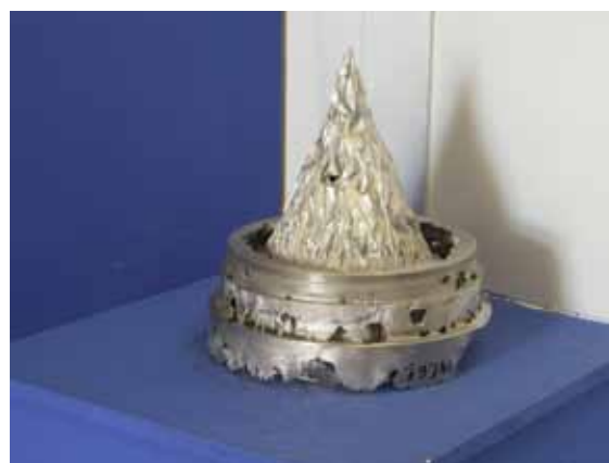
Iglasti zasun po abraziji s peskom v vodi
