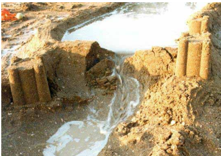
Slika 5: Pregrada oziroma krona je prebita, voda začneja v veliki količini iztekati iz akumulacije. Dolvodno od pregrade nastaja porušitveni val, ki bo še naraščal, dokler ne bo erozija v profilu pregrade dosegla dna doline (matične hribine), oziroma dokler se bo iztočna odprtina širila v globino in/ali v širino.
