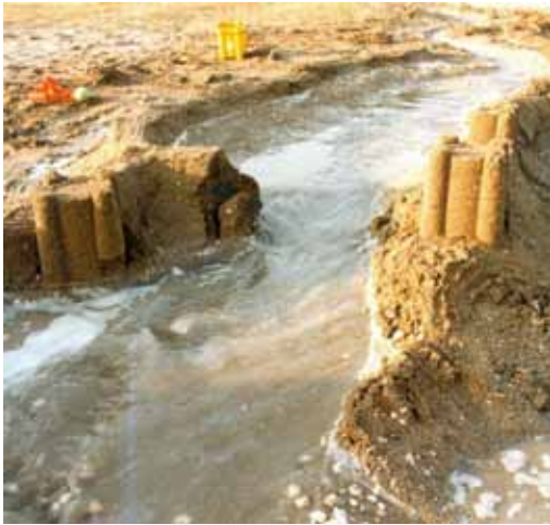
Slika 8: Odprtina ima končno dimenzijo, nivo akumulacije je že bistveno nižji kot ob nastopu preboja, kar pa je odvisno od dimenzij in oblike akumulacije. Akumulacija Teton se je spraznila v približno 5 urah.
