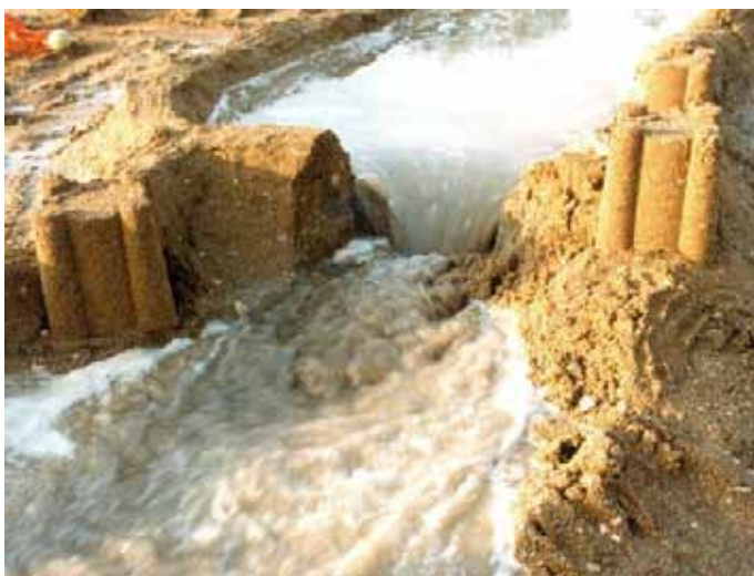
Slika 7: Odprtina na mestu preboja je skoraj že dosegla končne dimenzije, voda odteka z velikim hidravličnim padcem in tvori vodni skok, ki še dodatno krepi erozijo. V tej fazi začne gladina v akumulaciji hitreje upadati in porušitveni val se začne v profilu pregrade zmanjševati.
