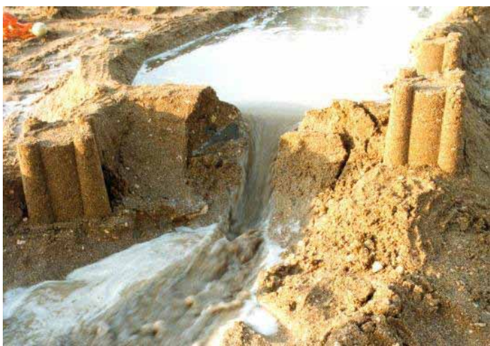
Slika 6: Odprtina na mestu preboja se širi, na modelni pregradi je na levi strani prebojne odprtine vidna črna barva jedra. Pregrada Teton je bila tesnjena s širokim glinenim jedrom in je imela praktično značaj homogene nasute pregrade.
