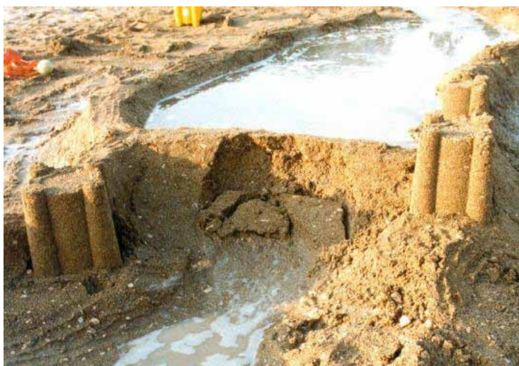
Slika 3: Erozijska napreduje proti kroni, odlomljeni kosi telesa so vedno večji, prav tako hitro narašča količina pronikle vode. Očividci rušenja pregrade Teton so 15 minut pred zrušitvijo krone govorili o odlomih »velikosti viličarja«, 30 sekund pred zrušitvijo krone o »velikosti manjšega tovornjaka«, tik pred zrušenjem pa že o »velikosti hiše«.
