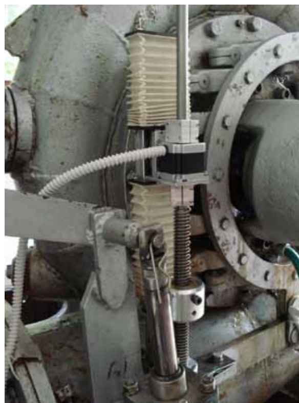
Slika 11: Koračni motor za nastavitev referenčne lege vodilnika
