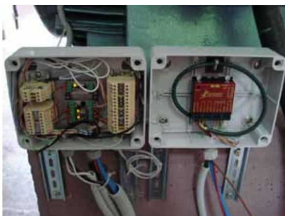
Slika 10: Napajalnik senzorjev (levo) in krmik koračnega motorja (desno)
