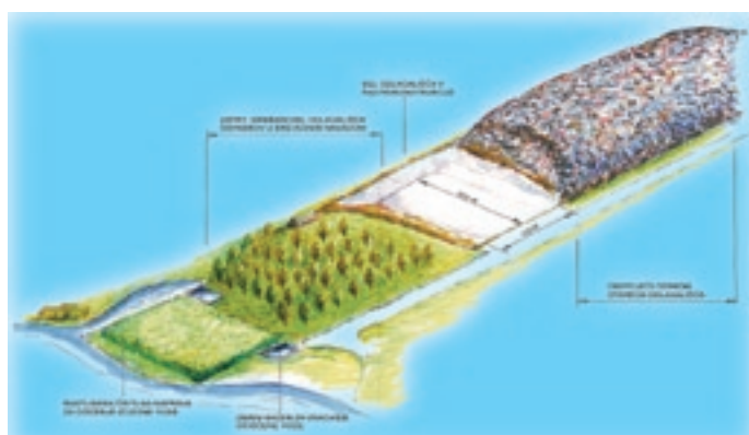
Slika 3. Trajnostna sanacija deponije. Izcedne vode se prečistijo na rastlinski čistilni napravi in se prek namakalnega sistema vračajo na deponijo. Rastline na površini deponije pripomorejo k čiščenju in s transpiracijo odvajajo vodo.
